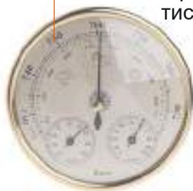
Барометр-анероїд – вимірює атмосферний тиск
