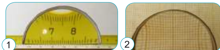
Мал. 14. Визначення збільшення лупи за допомогою: 1 – лінійок; 2 – міліметрового паперу
