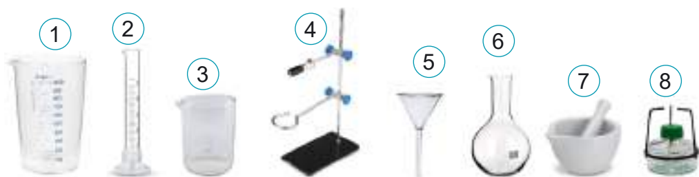
Мал. 21. Лабораторне обладнання: 1 – мензурка; 2 – мірний циліндр; 3 – склянка; 4 – штатив; 5 – лійка; 6 – колба; 7 – ступка з товкачиком; 8 – спиртовий пальник
