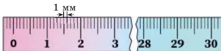
Мал. 22. Ціна поділки та межа вимірювання лінійки
